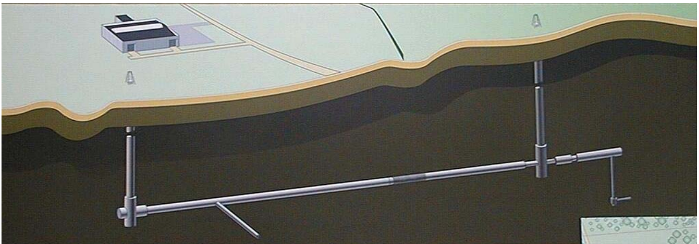
Een beeld van het ondergronds labo zoals het er nu uitziet, uitgezonderd de kleine horizontale PRACLAY-galerij links op de foto.
