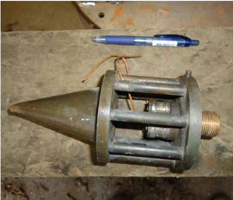
Les anciens paratonnerres et les anciens détecteurs de fumée étaient souvent radioactifs.
