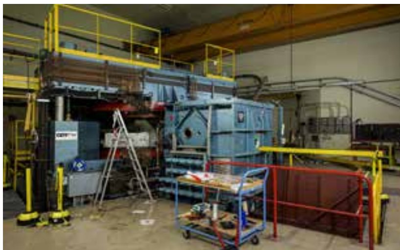
De deeltjesversnellers of cyclotrons werden gebruikt om medische radio-isotopen te produceren.
