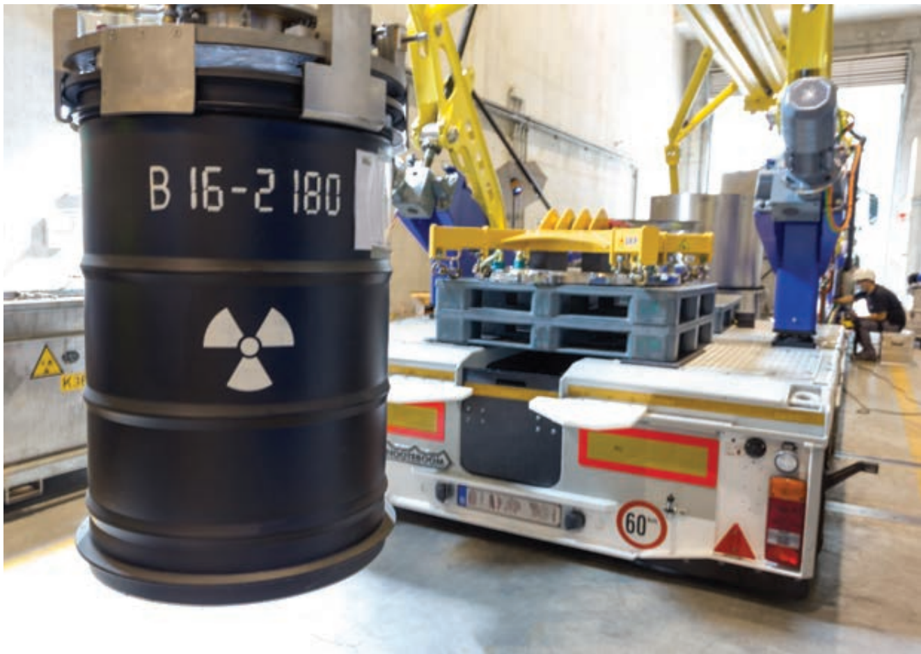
Een uitgekiend systeem voor laden en lossen – aangestuurd vanop afstand – neemt de vaten op.
