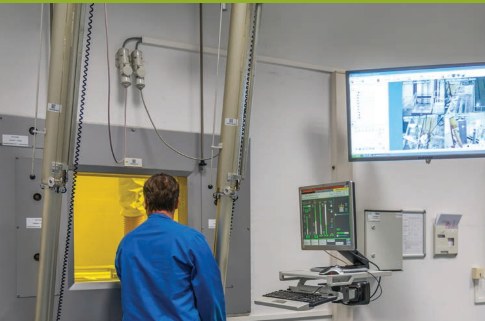
De operatoren van Belgoprocess inspecteren het afval vanachter een loodglasvenster van 1,2 meter dik.
