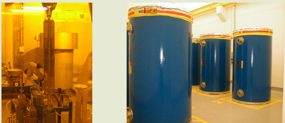
Figuur 8 – Ontlading bij Belgoprocess van bestraalde splijtstoffen van de onderzoeksreactor Thetis van de Universiteit Gent (bron: Belgoprocess) en opslag van bestraalde splijtstoffen van de onderzoeksreactor BR3 van het SCK•CEN in Castor-containers op site BP1 van NIRAS die door Belgoprocess geëxploiteerd wordt (bron: Belgoprocess/NIRAS).
