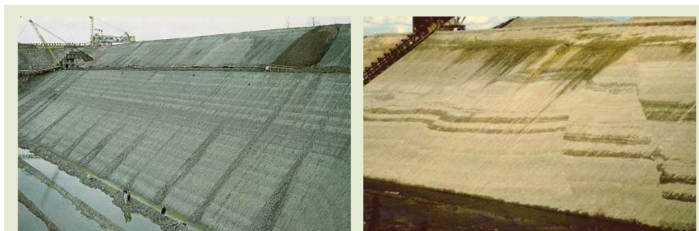
Figuur 33 – Links, algemeen beeld van een kleigroeve (Kruibeke) waar de karakteristieke strooksgewijze structuur van de Boomse Klei te zien is; rechts, algemeen beeld van een kleigroeve (Marke) waar dezelfde strooksgewijze structuur in de Ieperiaanklei te zien is, maar met structurele onderbrekingen (breuken).
