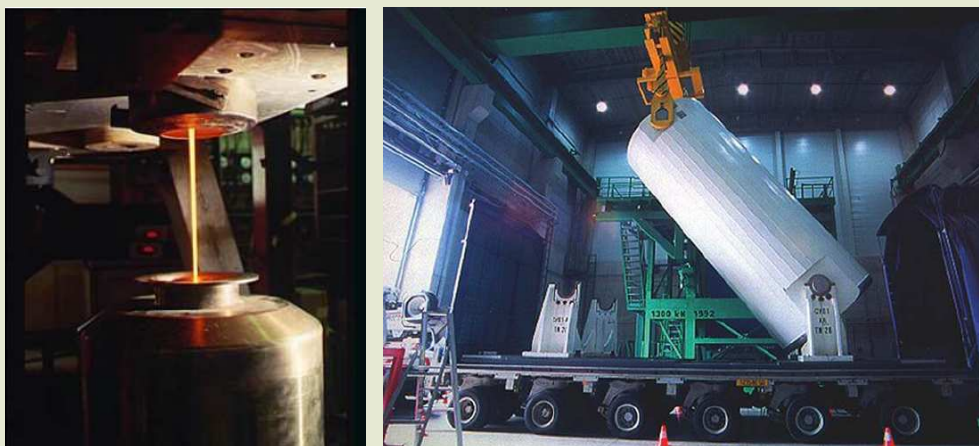
Figuur 9 – Vullen van een container verglaasd afval afkomstig van de opwerking (bron: AREVA NC) en overladen van een afgeschermd transportverpakking met 28 containers verglaasd afval (bron: Belgoprocess).
