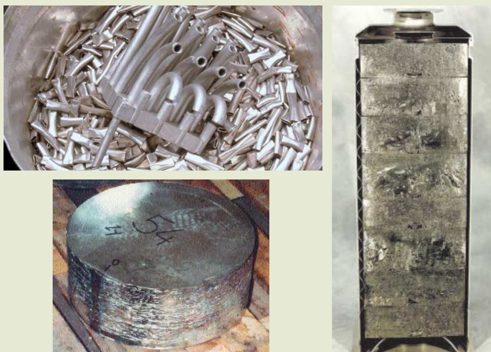
Figuur 14 – Metaalafval afkomstig van de opwerking van bestraalde splijtstoffen (bovenaan links) en datzelfde afval gecompacteerd tot schijven (onderaan links) en geplaatst in roestvrijstalen containers (rechts) (bron: AREVA NC).
