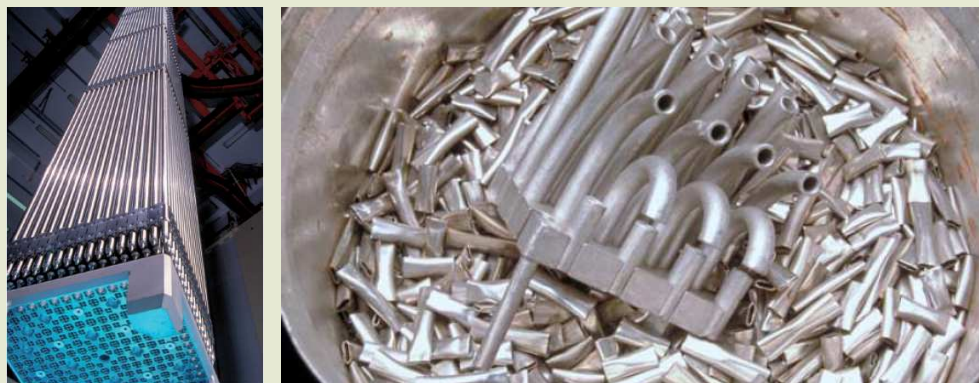
Figuur 7 – Splijtstofelement en metaalafval gerecupereerd bij de opwerking van splijtstoffen (bron: AREVA NC).
