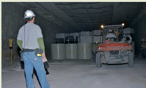
Geologische berging van militair afval in de WIPP-installatie, in een zoutlaag, in New Mexico (Verenigde Staten) (bron: USDOE).
