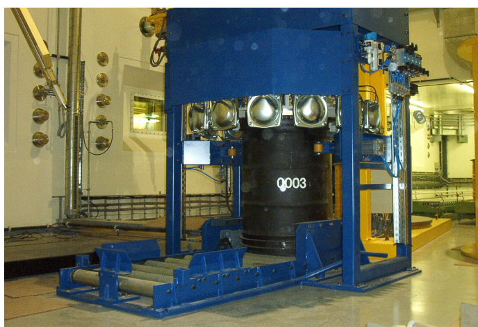
afbeelding 10: afsluiten van colli in de HRA/Solarium-installatie
