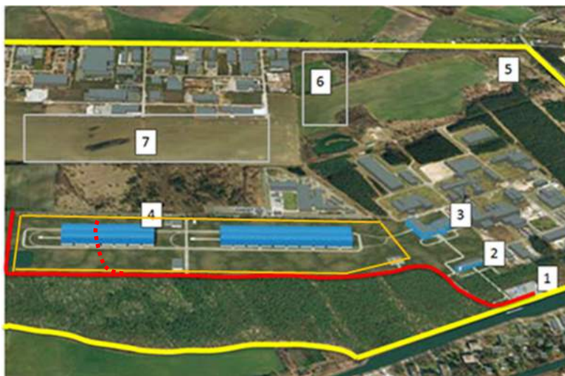
Figuur 4 - 3: Inplanting van de bergingssite (oranje vijfhoek) en van verschillende projectonderdelen. (1): kade; (2): caissonfabriek; (3): installatie voor de productie van monolieten (IPM); (4): bergingsmodules; (5): communicatiecentrum en proefopstellingen; (6): oostelijke uitbreiding van de kmo-zone; (7): zuidelijke uitbreidingszone; rode lijn: nieuwe verbindingsweg van de kade naar de site (deel met de stippellijn is de huidige situatie).
