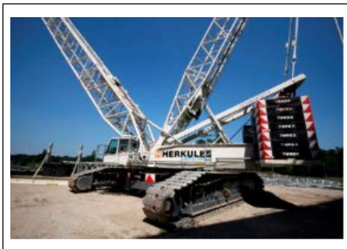
Figuur 8-42: Voorbeeld van een mobiele kraan 450 ton.
