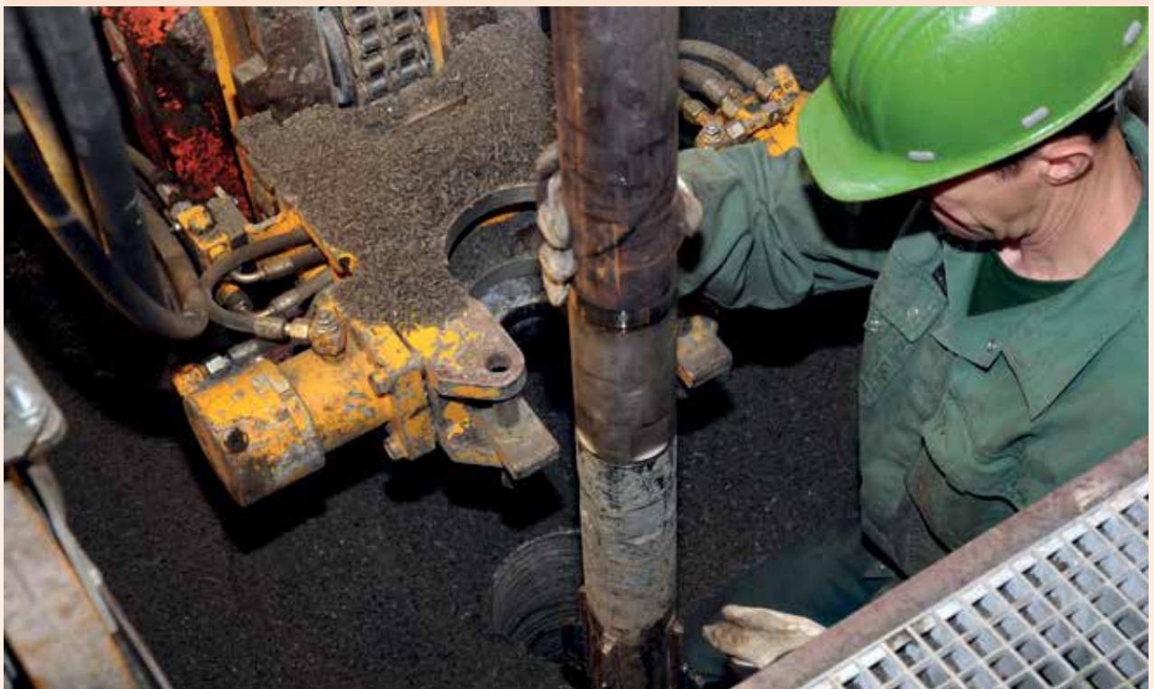
Boring in de Boomse Klei onder het HADES-onderzoekslaboratorium
