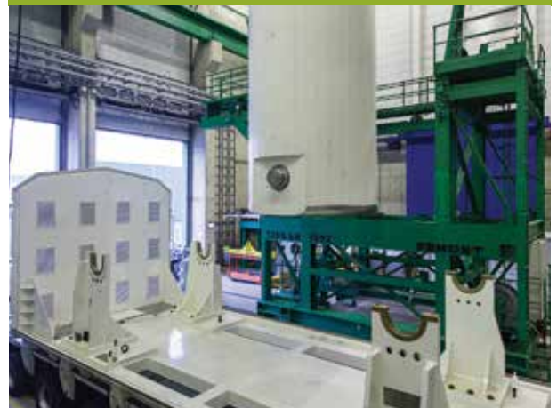
Déchargement de l'emballage de transport dans le bâtiment d'entreposage
