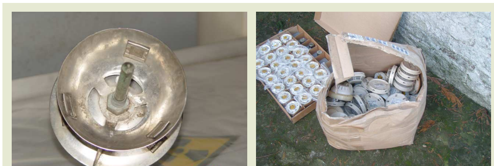
Figure 10 – Paratonnerre radioactif et détecteurs de fumée.
