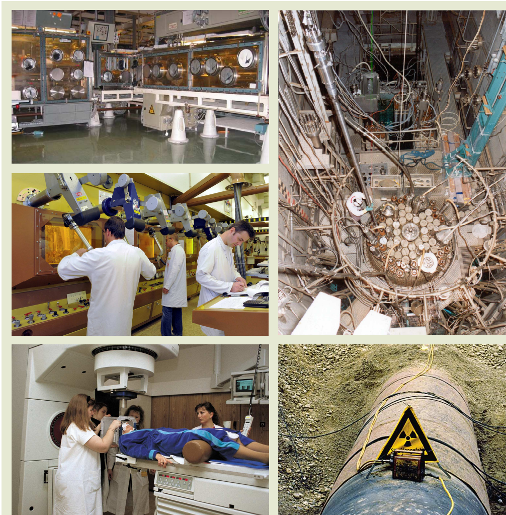
Figure 6 – De gauche à droite et de haut en bas : boîtes à gants (actuellement démantelées) utilisées dans le passé par Belgonucleaire pour la fabrication de combustibles nucléaires (source : Belgonucleaire) ; intérieur du cœur du réacteur de recherche BR2 du SCK•CEN (source : SCK•CEN) ; laboratoire de production de radioéléments (source : IRE) ; utilisation d'une source radioactive en radiothérapie (source : Nagra) ; contrôle des soudures d'une conduite au moyen d'une source radioactive (source : Nagra).
