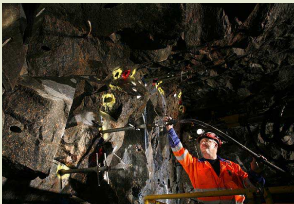
Investigations dans le laboratoire souterrain d'Aspö, en Suède, en vue de déterminer la faisabilité de la mise en dépôt de combustibles irradiés dans une roche cristalline (source : SKB).
