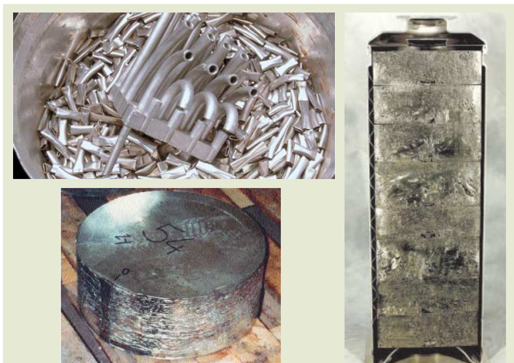
Figure 14 – Déchets métalliques issus du retraitement de combustibles nucléaires irradiés (en haut à gauche) et ces mêmes déchets compactés en galettes (en bas à gauche) puis mis dans des conteneurs en acier inoxydable (à droite) (source : AREVA NC).
