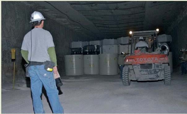
Mise en dépôt géologique de déchets militaires dans l'installation WIPP, dans une couche de sel, au Nouveau Mexique (Etats-Unis) (source : USDOE).
