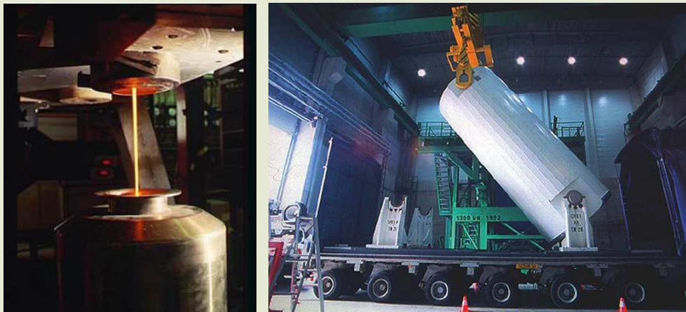
Figure 9 – Remplissage d'un conteneur de déchets vitrifiés issus du retraitement (source : AREVA NC) et transbordement d'un emballage de transport blindé contenant 28 conteneurs de déchets vitrifiés (source : Belgoprocess).
