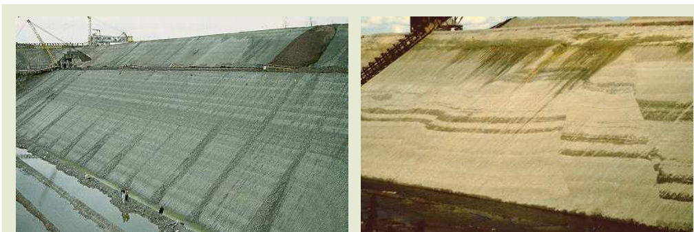
Figure 33 – A gauche, vue générale d'une argillère (Kruibeke) montrant la structure en bandes caractéristique de l'Argile de Boom ; à droite, vue générale d'une argillère (Marke) montrant le même type de structure en bandes dans les Argiles Yprésiennes, mais avec des discontinuités structurales (failles).
