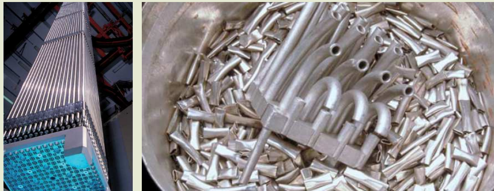
Figure 7 – Assemblage de combustible nucléaire et déchets métalliques récupérés lors du retraitement de combustibles (source : AREVA NC).
