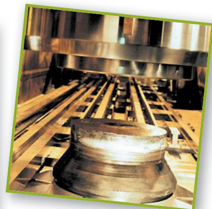
Compactering van hulzen en eindstukken, residu van de opwerking van bestraalde kernbrandstof
