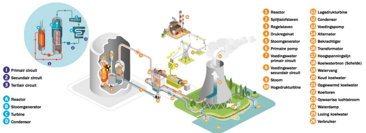
Figuur 8: Schematisch weergegeven werking van een kerncentrale
